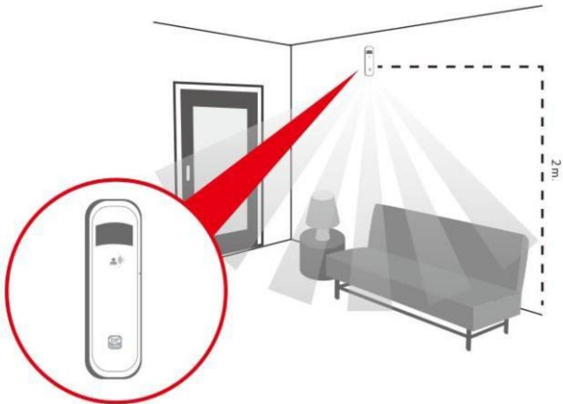
デバイスを床から2m以上のところに設置することをお勧めします。侵入者が通過する可能性の高い玄関や入口の範囲にセンサーが効率的に作動できます。
