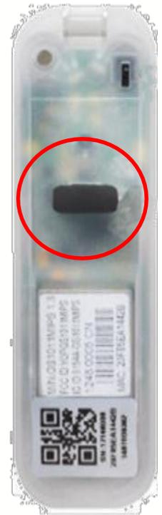
センサーの裏のQRコードをスキャンしてください。モーションセンサーがプリインストールされます。作動させるには、黒いストリップを引いて、電池と接触させる必要があります。
