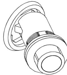
図3. ナットをベロ先端からくぐらせます。
