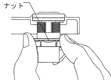
図5. 現行ストライク (1992年から製造)
