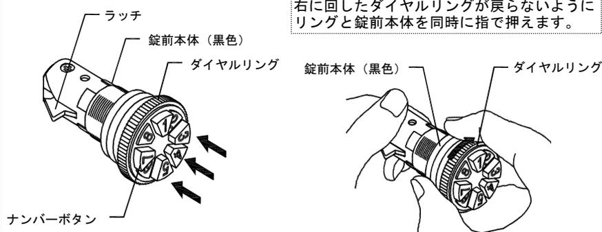
右に回したダイヤルリングが戻らないようにリングと錠前本体を同時に指で押えます。
