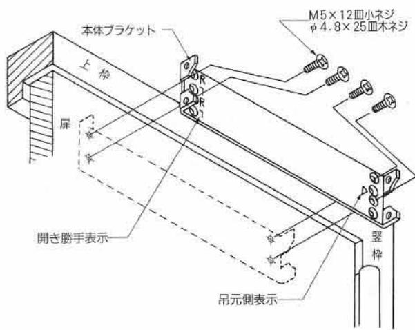
a) 本体ブラケットの▷印を吊元側に向けて扉面に取り付ネジ（4本）にて取付けて下さい。
