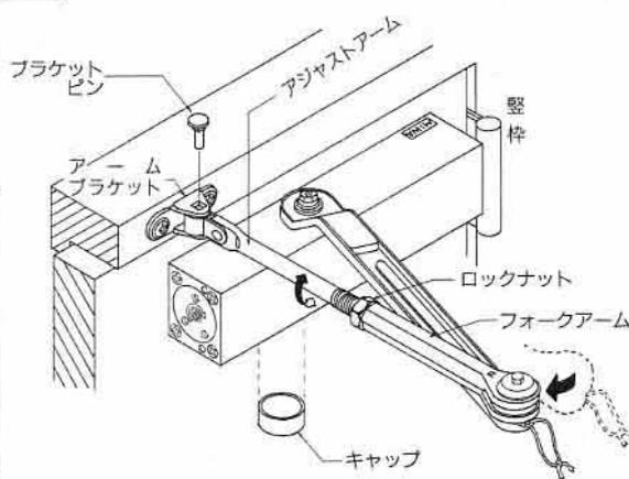
a) アジャストアームをアームブラケットにブラケットピンにて連結して下さい。その時、フォークアームは扉面又は上枠面と直角になるように、ロックナットを緩めアジャストアームをネジリ、長さを調節して下さい。
