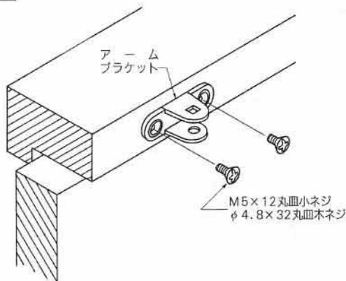
a) アームブラケットを上枠見付面に取り付ネジ（2本）にて取付けて下さい。
