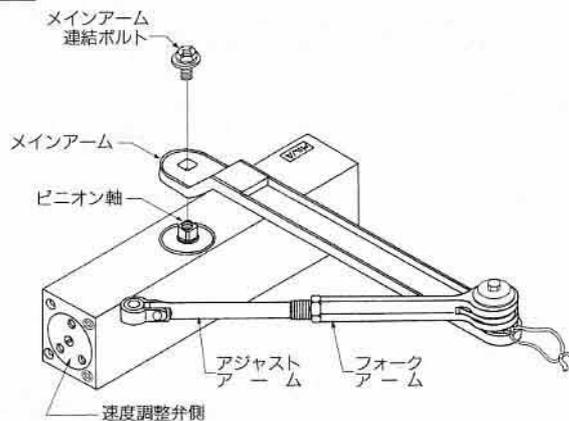
a) 本体の向きは速度調整弁を吊元の反対側に向けて下さい。
