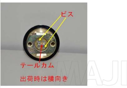
テールはマイナスビス**2**本で取り付けています。キーは抜いた状態で作業してください。差した状態では絶対に作業しないでください 。(内筒が抜けて部品がばらばらになってしまう可能性があります)
