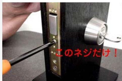
錠前本体の真ん中近くのネジだけを反時計回しに回して下さい。
