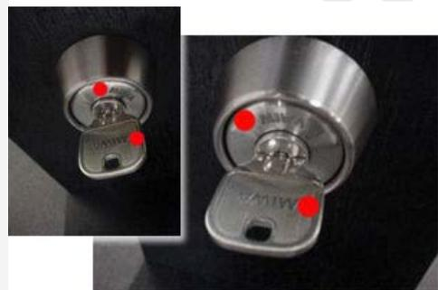
シリンダー本体のみを時計回りに回し、**MIWA**の文字が向かい合わない状態で止まりましたら、シリンダーを少し半時計回りに回して、左写真の様に**MIWA**の文字が向き合う状態にします。
