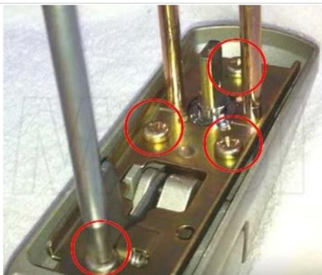
四か所ネジを外し、上部取付板を外します
