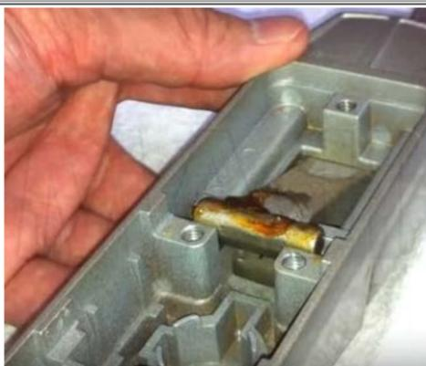
シリンダーを外し、新シリンダーに交換します
