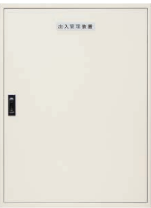
出入管理装置 [板金製] WA-08A [8ゲート(扉)] 700 (W)×900 (H)×200 (D) UPSを内蔵することにより 約30分間の停電補償。
