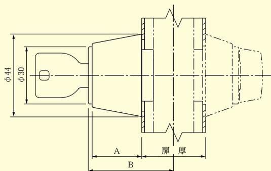
●扉厚によるA、B寸法図(単位mm)
