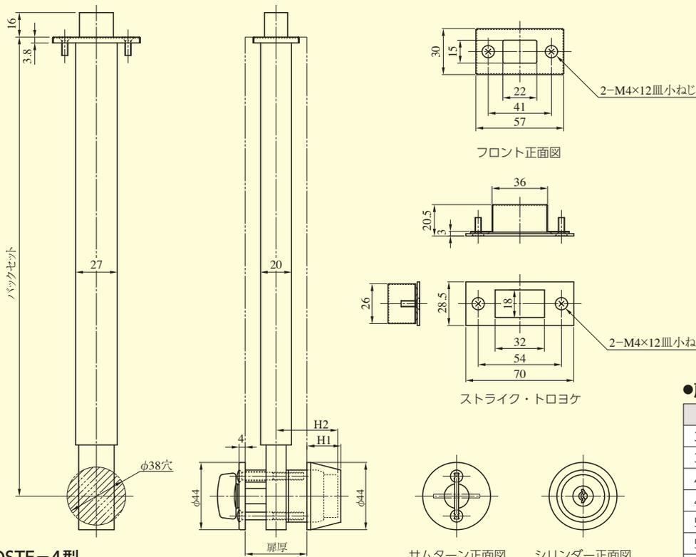
●扉厚によるH<sub>1</sub>、H<sub>2</sub>寸法(単位mm)
