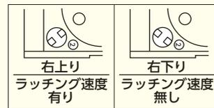
ラッチング速度と2速の調整弁は共用ですので、2速を適当な速度に調整した後でラッチング速度の調整を行なってください。(左記の調整弁の角度によって決まります。)
