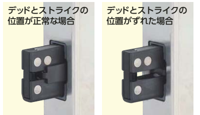
メインデッド、サブデッドとも突出 サブデッドとストライクが干渉し、メインデッドのみ突出
