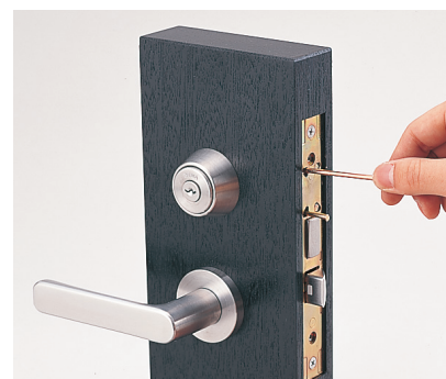
③ シリンダー止めピンを完全に引き抜きます。
