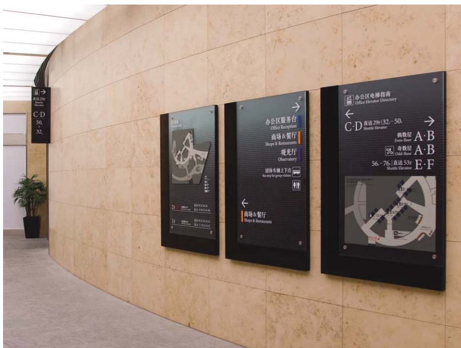
スチール折曲加工、焼付塗装仕上、強化ガラスシルク印刷
