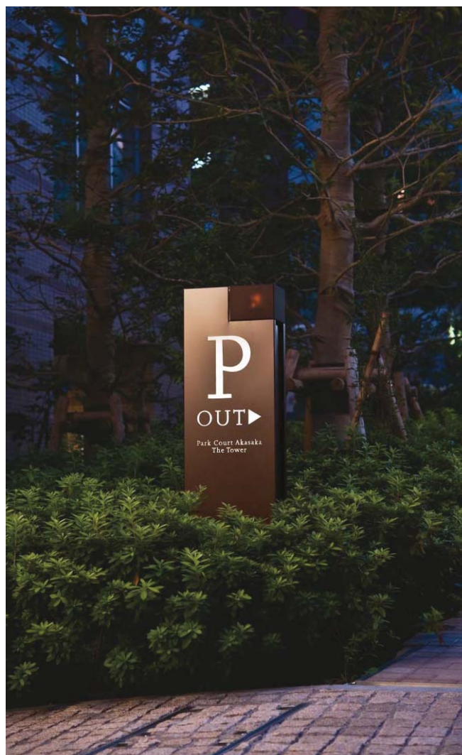
ステンレス加工品、焼付塗装仕上、FL内照式、パトライト
