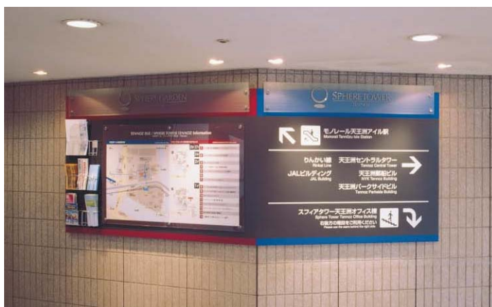
本体：スチール折曲加工焼付塗装仕上 表示：アクリルガラス加工、ABS樹脂切文字加工、クロームメッキ仕上 インクジェット出力シート+シート切文字加工貼り
