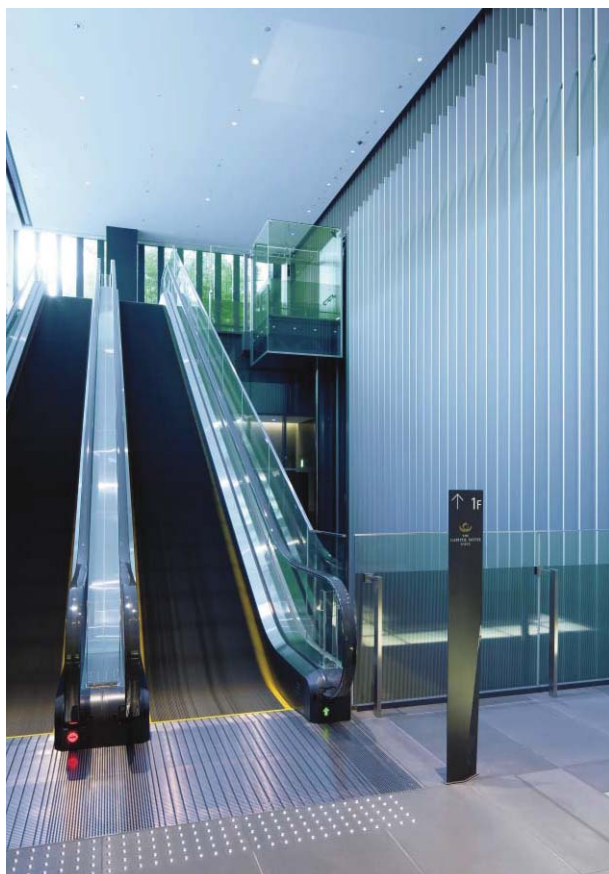
本体：スチール曲げ加工、指定色焼付塗装仕上 表示：シルク印刷
