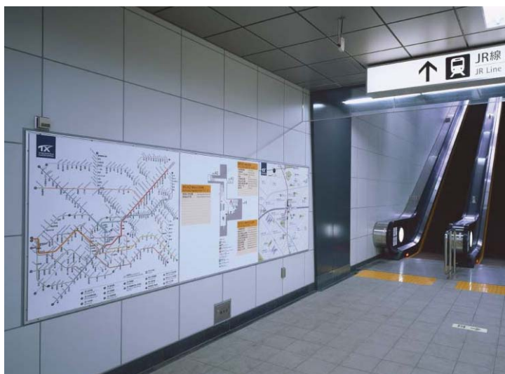
ステンレス折曲加工、アルミ板加工、焼付塗装仕上、インクジェット出力シート貼り
