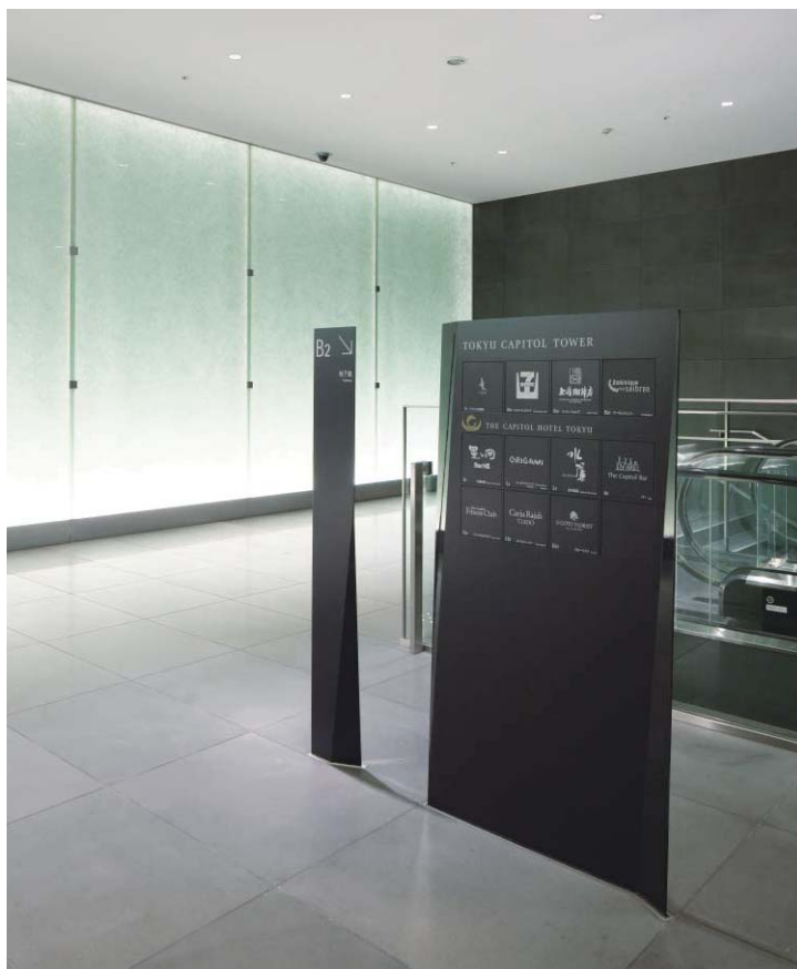
【左側】 本 体：スチール曲げ加工、指定色焼付塗装仕上／表示：シルク印刷 【右側】 本 体：スチール曲げ加工、指定色焼付塗装仕上 表示板：スチール板加工、指定色焼付塗装仕上、マグネット着脱式、シルク印刷
