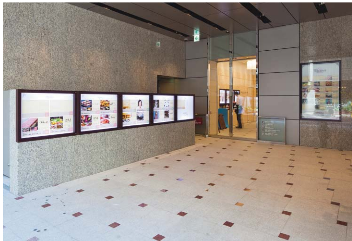
ステンレス折曲加工焼付塗装仕上、導光板+アクリル乳半加工、インクジェット出力加工貼り、LEDユニット内蔵
