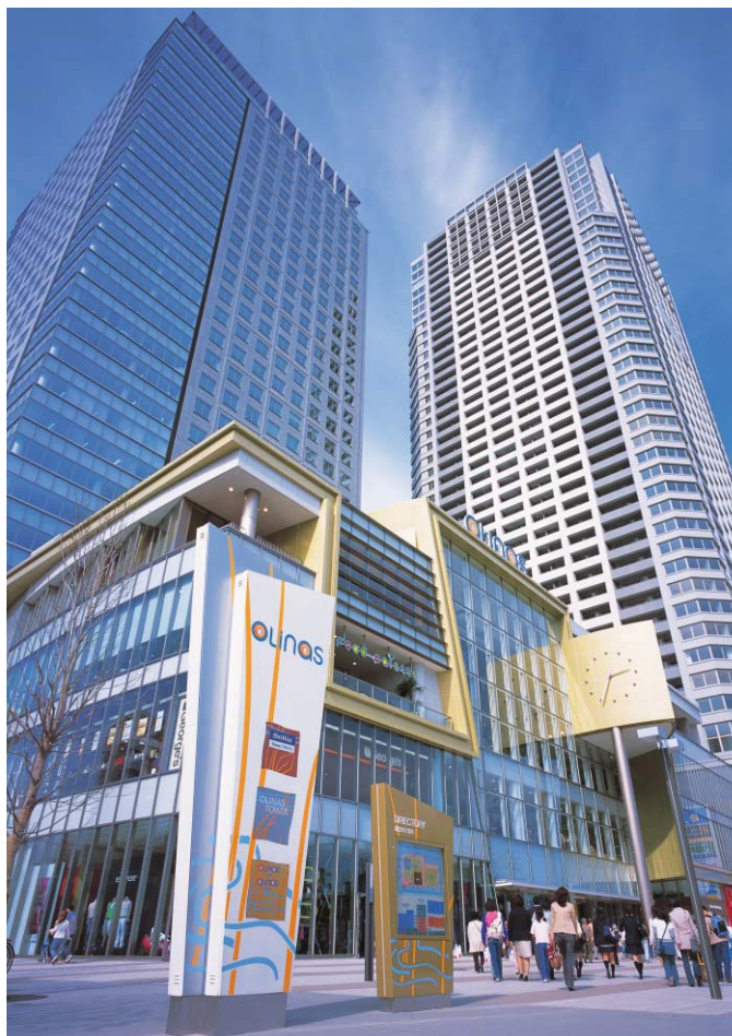
ステンレス折曲加工焼付塗装、アクリル象眼、透過性シート貼り、FL管内照式、表示部分：インクジェット出力
