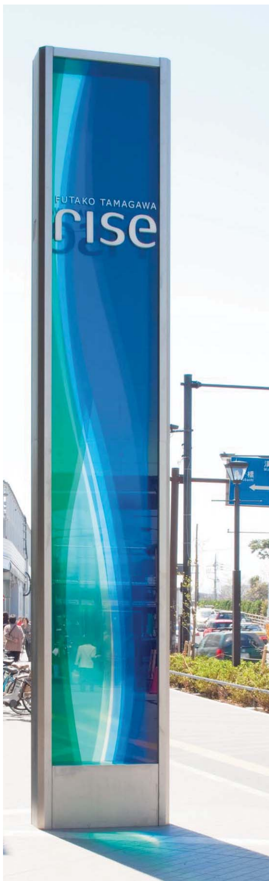
本 体：ステンレス曲げ加工、ショットブラスト仕上 表示板：強化ガラス加工、透明シート出力加工貼り 文 字：ABS樹脂加工、側面指定色塗装仕上、高輝度チップ型LED内蔵
