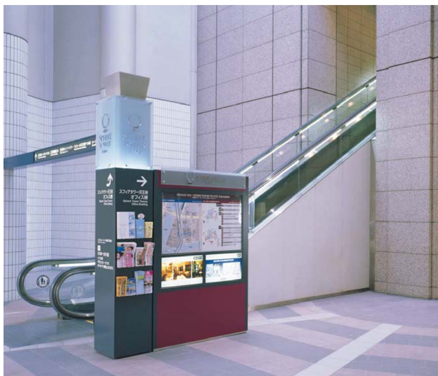
本体：スチール折曲加工焼付塗装仕上 表示：アクリルガラス加工、ABS樹脂切文字加工、クロームメッキ仕上 インクジェット出力シート+シート切文字加工貼り
