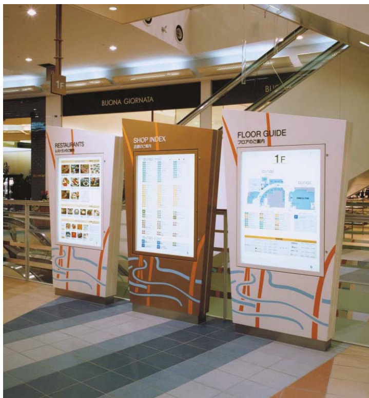
スチール折曲加工焼付塗装、乳半アクリルFL管内照式 表示部分：インクジェット出力
