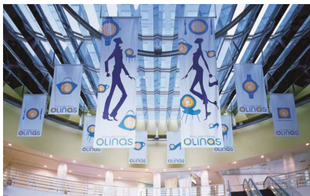
バナーサイン：インクジェット出力、四方ステッチ加工、ステンレスブラケット
