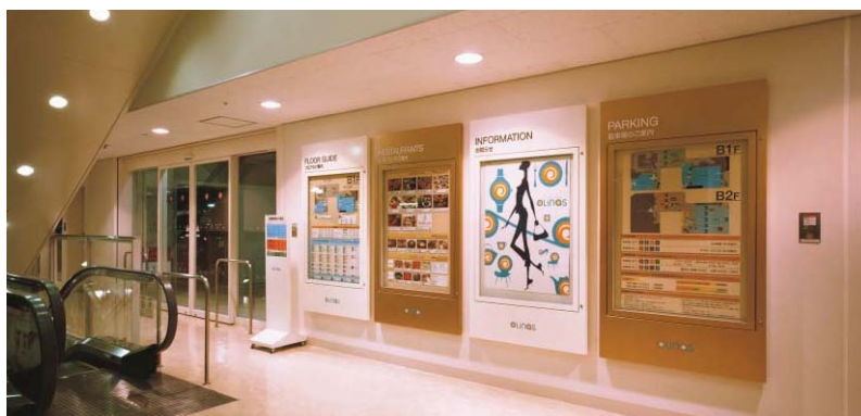
スチール折曲加工焼付塗装／表示部分：インクジェット出力
