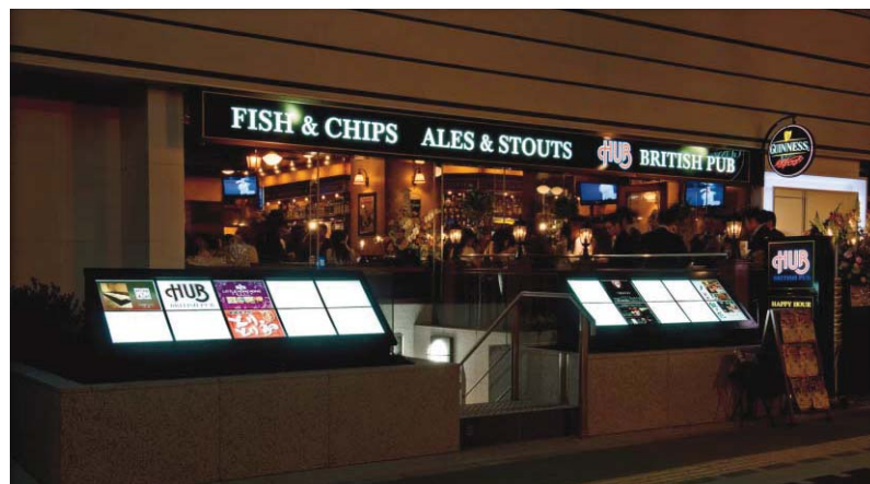
ステンレス加工品、焼付塗装仕上、FL内照式、インクジェットシート貼り
