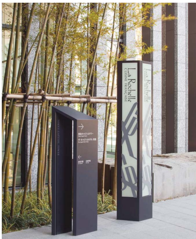
【誘導サイン（左）】 本体：ステンレス曲げ加工焼付塗装／表示：ABS樹脂切文字塗装仕上＋シルク印刷 【名称サイン（右）】 本体：ステンレス曲げ加工焼付塗装／表示：強化ガラス加工、乳半フィルム裏貼り、シルク印刷 照明：スポットライト防水型内蔵
