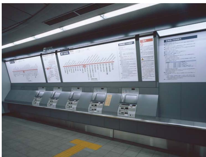
乳半アクリル板加工、透過性インクジェット出力シート貼り
