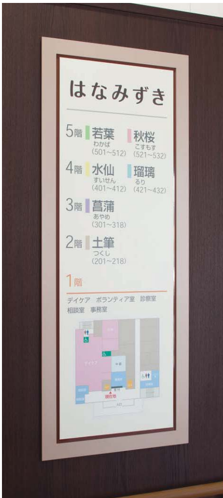
アルミ板フレーム加工焼付塗装仕上、アルミ複合板インクジェット出力貼り(ラバーマグネット裏貼り)
