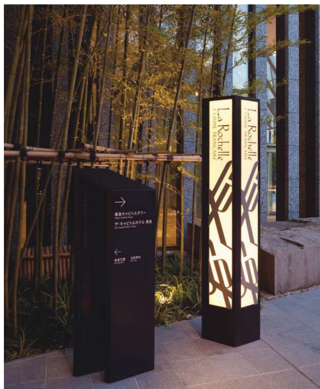
【誘導サイン（左）】 本体：ステンレス曲げ加工焼付塗装／表示：ABS樹脂切文字塗装仕上＋シルク印刷 【名称サイン（右）】 本体：ステンレス曲げ加工焼付塗装／表示：強化ガラス加工、乳半フィルム裏貼り、シルク印刷 照明：スポットライト防水型内蔵
