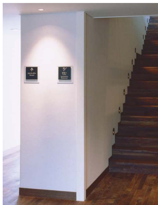
ガラスアクリル、アルミ板電解着色、パイブレーション仕上、シルク印刷
