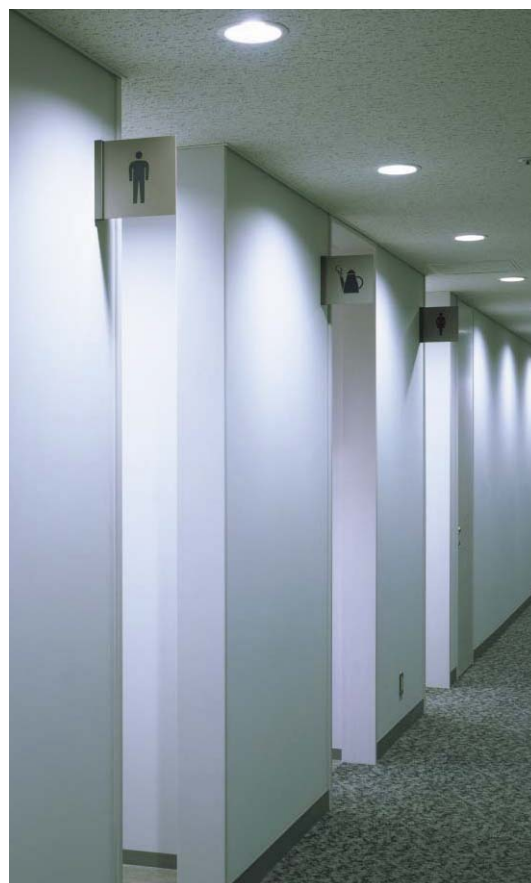
スチール曲げ加工、焼付塗装、アクリル板塗装仕上、シート切文
