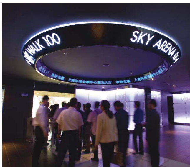
スチール折曲加工焼付塗装、LED透過光内照式、LEDユニット内蔵
