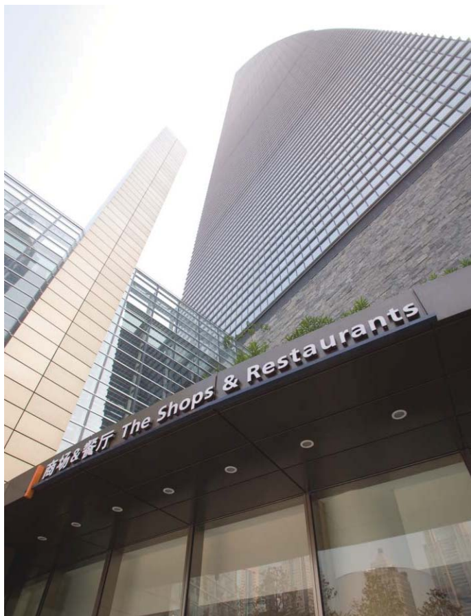
ステンレス箱文字加工、乳半アクリルLED表面発光
