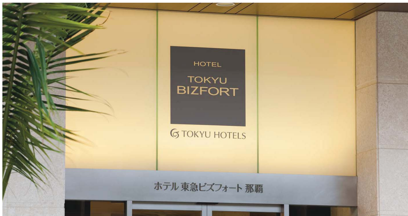
塩ビシートベタ抜き加工、塩ビシート切文字貼り、ガラス背面プラストシートベタ貼り、ABS樹脂切文字加工貼り
