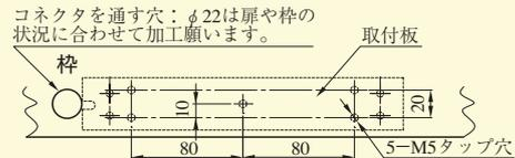
【B矢視図：ストライクプレート取付用扉加工図】
