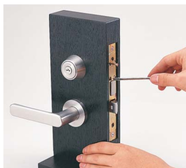
②シリンダー側のシリンダー止めピンを少し引き出します。なお上下のピンが一体になっているタイプもあります。（LHシリーズ等）
