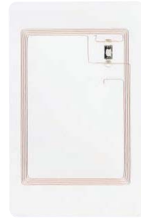
【カード内部構造 (IC)】
