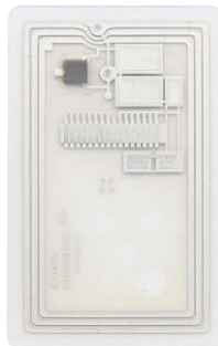
【カード内部構造 (IC)】
