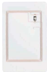
【カード内部構造(IC)】
