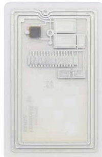
【カード内部構造(IC)】
