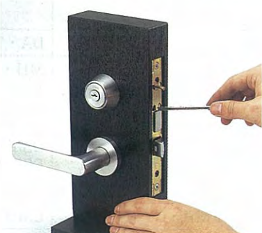
2. シリンダー側のシリンダー止めピンを少し引き出します。なお上下のピンが一体になっているタイプもあります。(LHシリーズ等)
