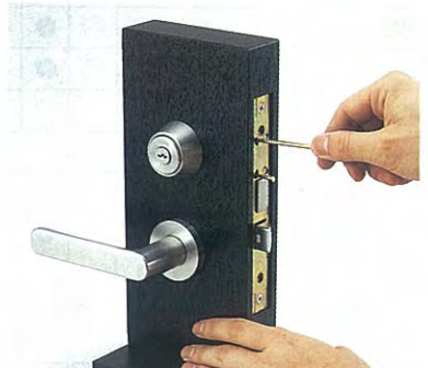
3. シリンダー止めピンを完全に引き抜きます。
