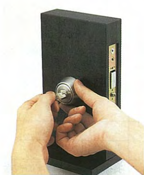
4. キーを押さえながらシリンダーリングを持って左方向へ回します。
