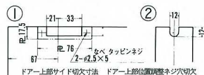
アームセットプレート取付ドア切欠詳細図 (切欠箇所はカバープレートで隠す)
