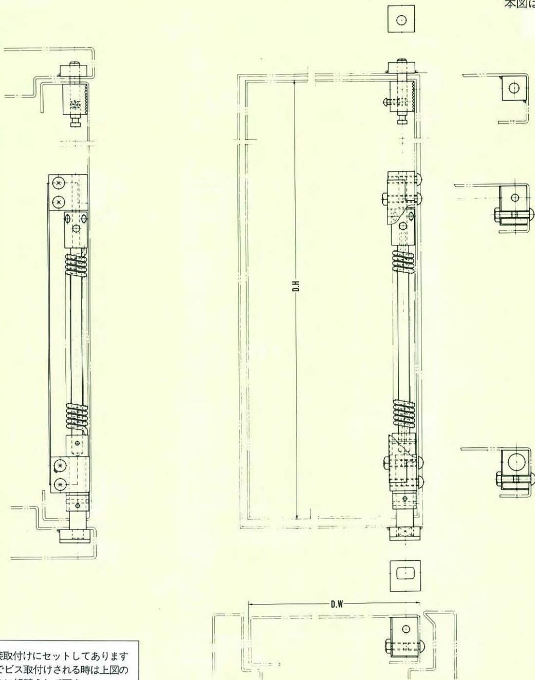
(注) 溶接取付けにセットしてありますのでビス取付けされる時は上図のように組替えて下さい。
