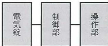
また、電気錠を正しく作動させるためには、建具工事だけでなく電気工事も必要です。配管・配線はもちろんですが、結線や機器の取付等、最初から施工区分を明確にしてください。
