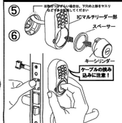
⑤ドアとキーシリンダーの隙間にあわせたスペーサーの枚数とキーシリンダーをICマルチリーダー部の中に入れます。
