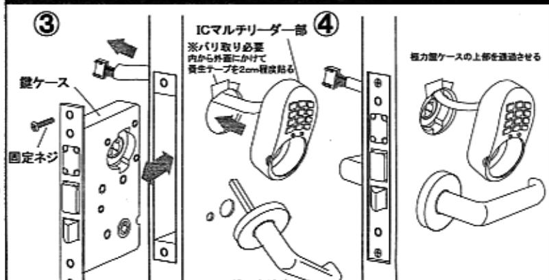
③ドアハンドルを外して、鍵ケースの固定ネジを外し、鍵ケースを引き出します。但し、キーシリンダーを取り外した穴にケーブルを通せる隙間があれば、鍵ケースを外す必要はありません。
